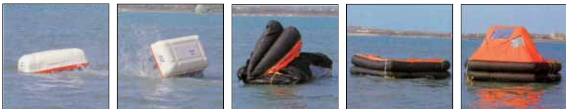
Arriba: Secuencia fotográfica del lanzamiento de una balsa salvavidas. En la última imagen se observa que la balsa queda totalmente desplegada.
