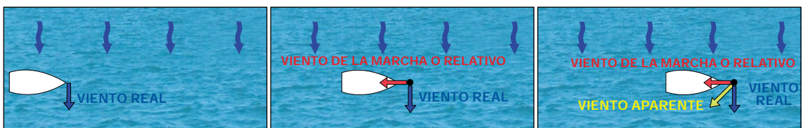
Cuando el barco avanza, genera un viento que se denomina viento de la marcha y que tiene dirección justo opuesta a nuestro rumbo e intensidad igual a nuestra velocidad. La resultante del viento real y del viento de la marcha, se llama viento aparente.
