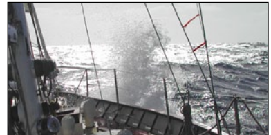
Catavientos de color rojo en la jarcia de un velero. Su dirección es la del viento aparente.
