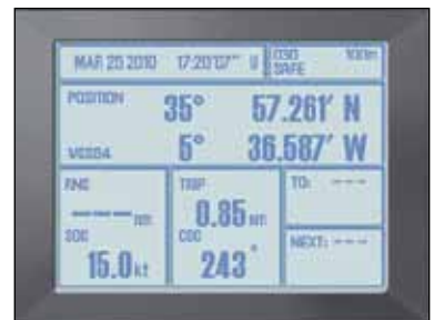
Información primaria de un terminal GPS ofreciendo nuestras coordenadas geográficas en grados, minutos y milésimas de minuto con una precisión de hasta menos de 10 metros de error
