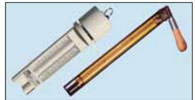
En el psicrómetro de Asmann (izquierda) la circulación forzada del aire sobre los bulbos de los termómetros se obtiene mediante un ventilador movido por un resorte de relojería. En el psicrómetro de Honda (derecha), la circulación se obtiene manualmente al hacer girar el conjunto mediante la manivela en forma de honda o molinillo.
