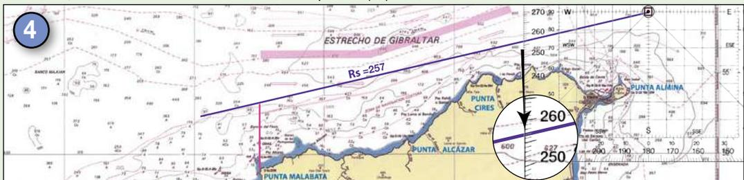
4 Con el transportador, medimos nuestro rumbo de superficie.  $R_s = 257^{\circ}$ .
