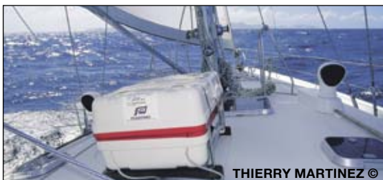
Frente a los sacos, el container presenta unas garantías de protección mayores. La balsa está mejor protegida y puede fijarse a un soporte previsto
